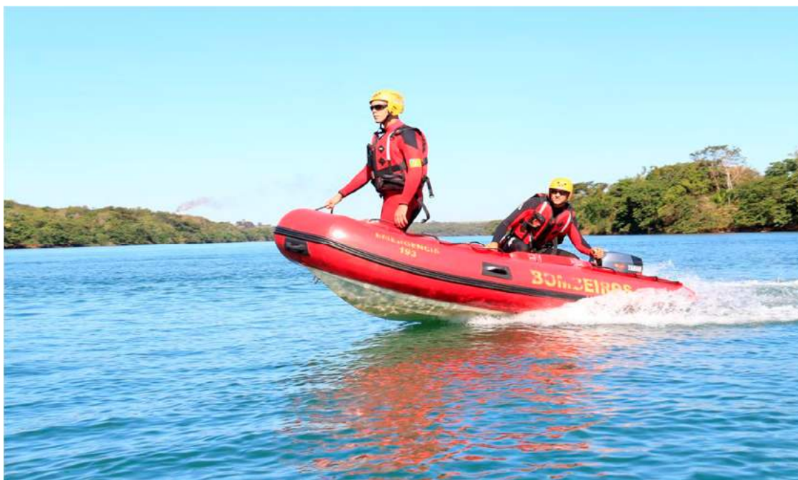
Figura 32 – Bote inflável com casco rígido para salvamento (misto).
