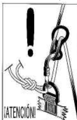
¡Atención! Montaje rápido en simple: sólo para autodescuelgue y rápel guiado.
