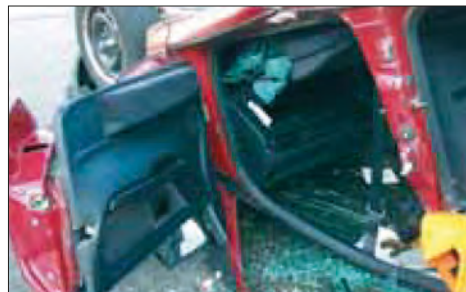
Imagen 230. Retirada de la puerta
