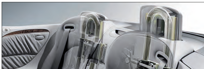
Imagen 64. Arco de seguridad de vehículos descapotables
