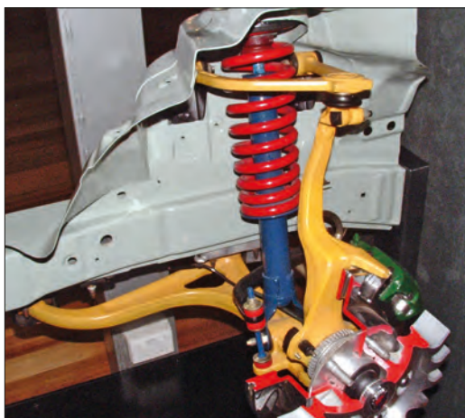
Imagen 48. Amortiguador tipo McPherson
