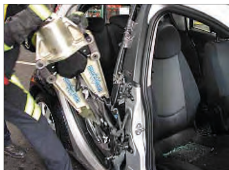
Imagen 313. Aplicación del separador por arriba
