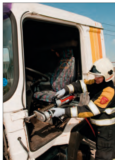
Imagen 339. Instalación del cilindro de rescate.
