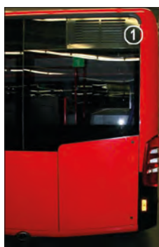
Imagen 112. Entrada de aire al motor en autobuses
