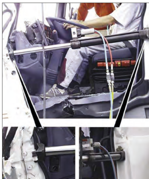
Imagen 338. Instalación del cilindro de rescate
