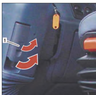
Imagen 333. Desbloqueo manual con seguro mecánico
