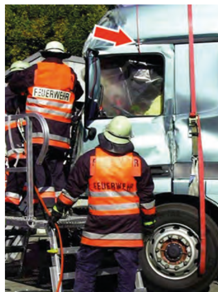
Imagen 329. Aseguramiento de la puerta con cuerda
