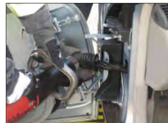
Imagen 194. Corte de cables
