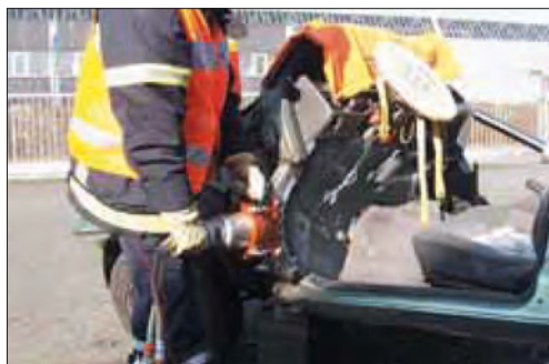
Imagen 300. Levantamiento del salpicadero
