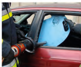
Protección en el corte de montantes
