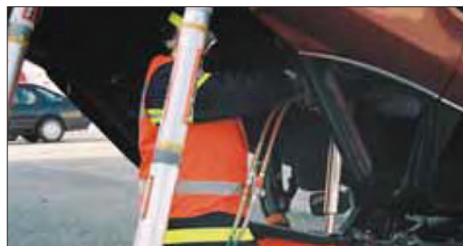
Imagen 280. Retirada de techo con cilindro separador
