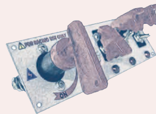
Imagen 118. Distinción del Interruptor NOT AUS y el pulsador de bloqueo de frenos
