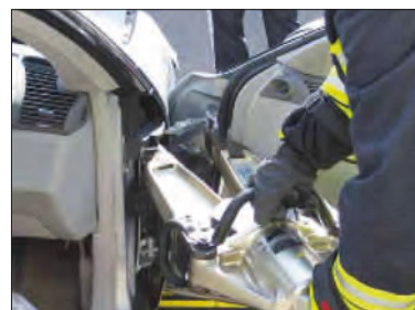
Imagen 218. Retirada de la puerta delantera
