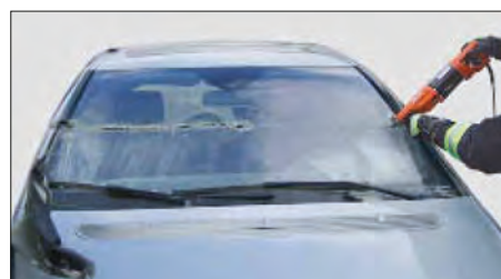
Imagen 250. Corte del parabrisas
