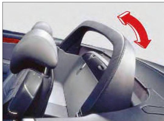
Imagen 70. Arco protector integrado en la estructura
