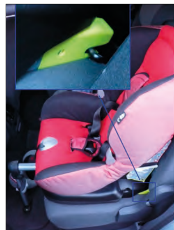
Imagen 73. Sistema Isofix de fijación de sillas infantiles
