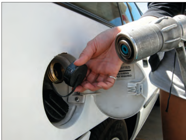
Imagen 34. Tapa de llenado con depósito de gas
