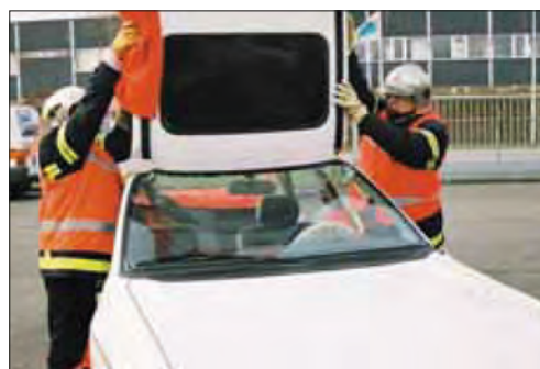
Imagen 262. Maniobra de abatimiento del techo hacia delante
