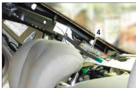
Imagen 254. Generador de gas del montante C (4)
