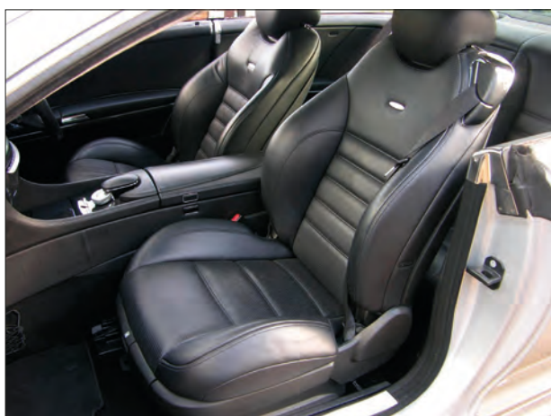
Imagen 79. Sistema de cinturón integrado en el asiento
