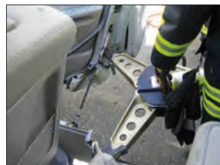
Imagen 216. Maniobra de separación
