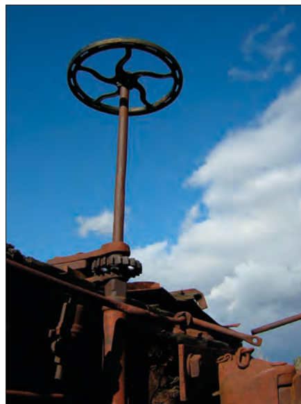
Imagen 25. Freno de seguridad
