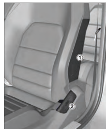
Imagen 177. Airbag lateral de cabeza y tórax (1) y airbag para pelvis (2)
