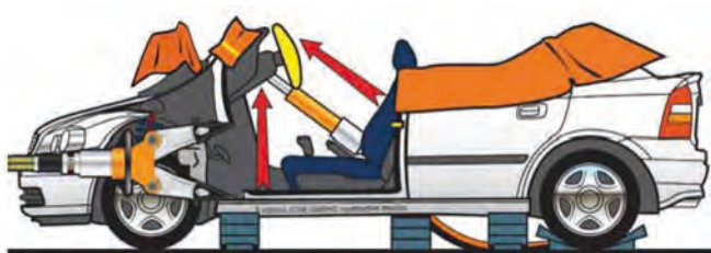
Imagen 293. Levantamiento del salpicadero
