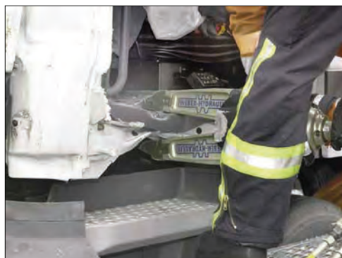
Imagen 337. Aplastamiento del umbral
