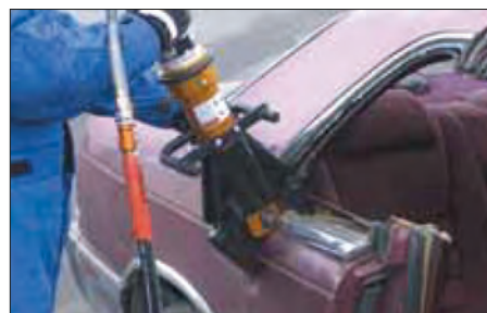
Imagen 223. Corte de alivio en el pilar C
