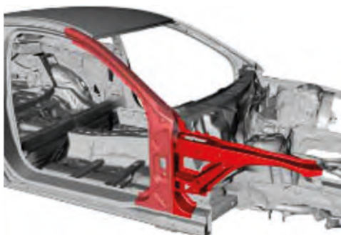
Imagen 294. Refuerzo de montante A y larguero
