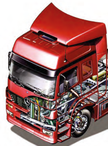
Imagen 320. Estructura de la cabina del camión
