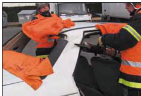
Imagen 260. Corte de los pilares B y C
