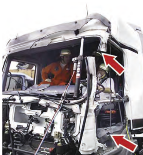
Imagen 341. Cortes de descarga (flechas) y cilindros colocados
