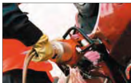
Imagen 232. Separación de la puerta de su estructura
