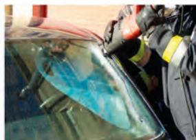
Protección en el corte de cristal laminado
