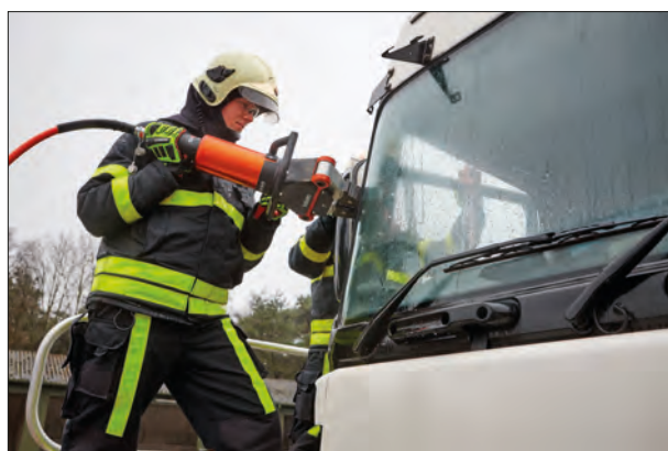
Imagen 328. Eliminación de la puerta con el separador
