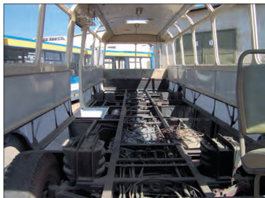
Imagen 342. Estructura de un autobús
