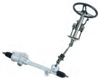
Imagen 66. Columna de dirección articulada
