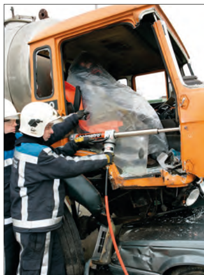
Imagen 340. Instalación del segundo cilindro de rescate
