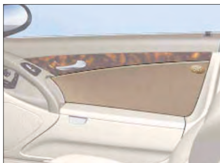
Imagen 174. Airbags laterales delantero en revestimiento de puerta
