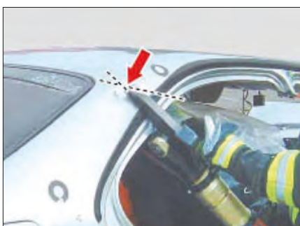
Imagen 264. Corte de descarga
