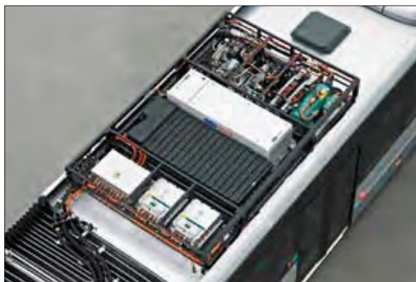
Imagen 42. Grupos auxiliares de accionamiento eléctrico y baterías
