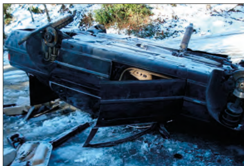
Imagen 155. Vehículo con techo colapsado
