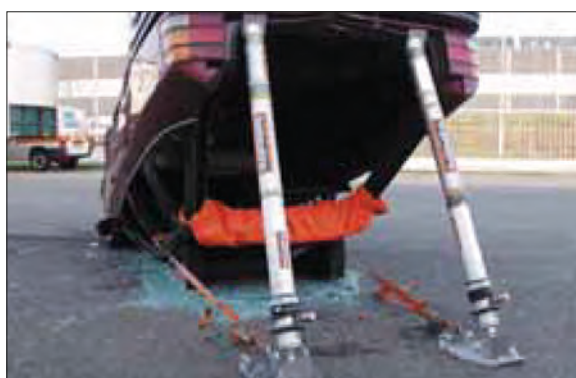
Imagen 275. Apuntalamiento de la parte posterior del vehículo
