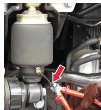
Imagen 321. Lugar de corte de la tubería de aire del fuelle neumático
