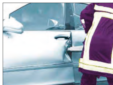
Imagen 188. Apertura de cerradura utilizando separador
