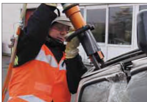
Imagen 270. Corte del pilar B
