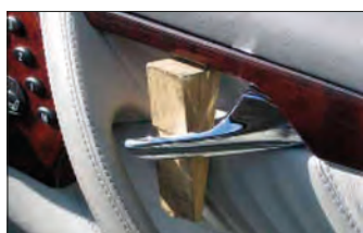
Imagen 193. Colocación de cuña bajo el accionamiento interior
