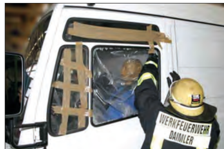
Imagen 184. Forma de cortar los cristales
