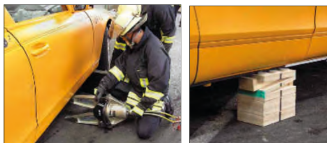
Imagen 146. Vehículo elevado con separador
