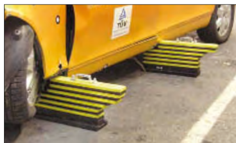
Imagen 147. Apoyar por debajo con bloques corredizos para bajar el vehículo
