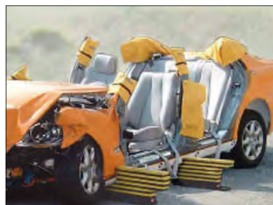
Imagen 257. Protección de aristas de corte
