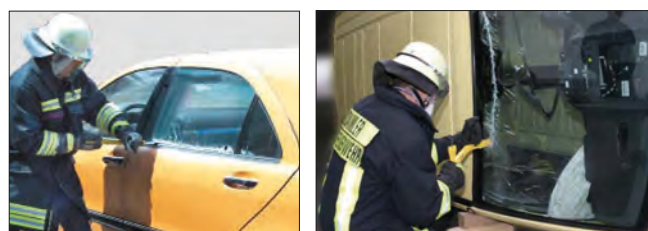
Imagen 184. Forma de cortar los cristales
