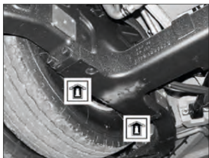
Imagen 164. Ejes (soporte de fuelles neumáticos)
