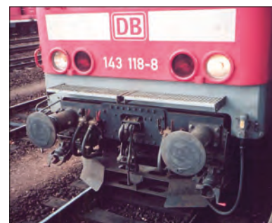
Imagen 23. Semiacoplamientos
