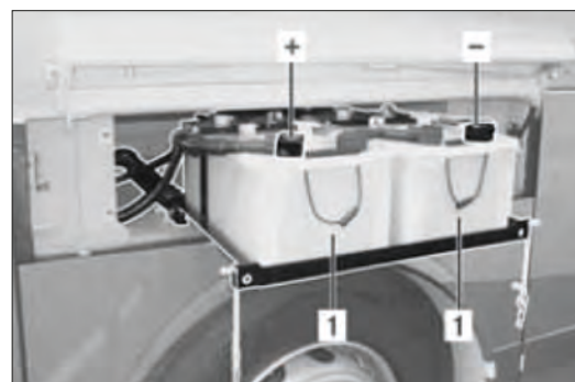
Imagen 125. Baterías en carro extraíble
