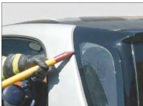
Imagen 186. Extracción de cristales con palanqueta
