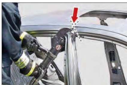
Imagen 253. Corte del montante B con refuerzos estructurales
