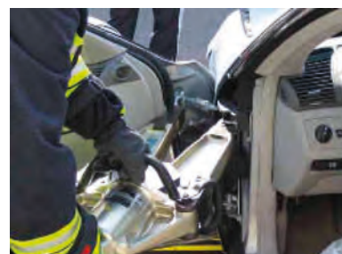
Imagen 195. Retirada de la puerta
