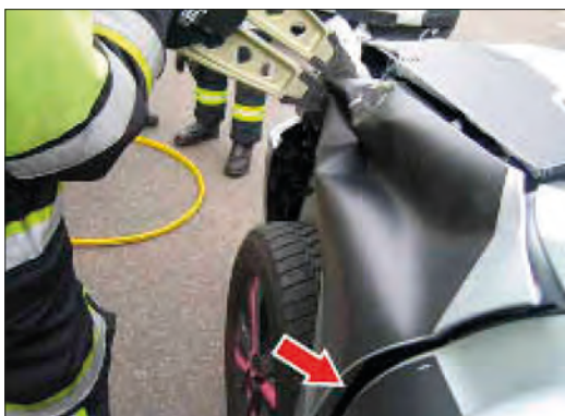
Imagen 197. Retirada de la aleta
