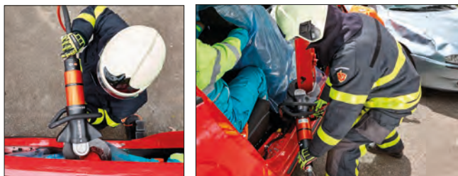
Imagen 212. Cortes del pilar B
