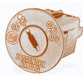
Imagen 87. Desactivación del airbag del acompañante
