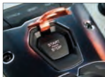
Imagen 108. Parada del motor de coche automático o arranque sin llave
