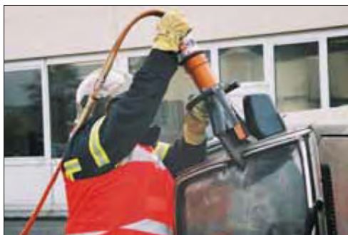
Imagen 268. Corte del montante A
