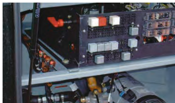
Imagen 127. Desconectador acoplado a la caja de fusibles
