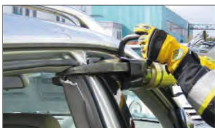
Imagen 252. Corte del montante B por la parte superior
