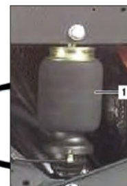
Imagen 322. Fuelle neumático (1) de la suspensión de la cabina
