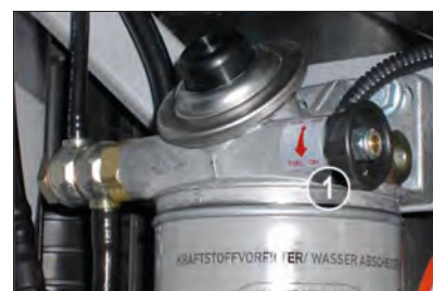
Imagen 116. Cortar el suministro de combustible
