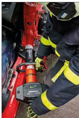
Imagen 214. Corte de alivio del pilar B
