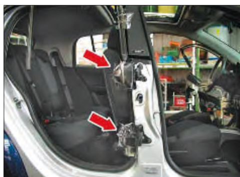
Imagen 314. Recubrimiento de cantos afilados con cubiertas protectoras
