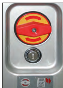
Imagen 350. Llave de emergencia exterior. Ejemplo de Autobús urbano
