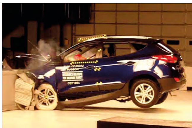
Imagen 2. Transmisión de fuerzas por el diseño estructural en una colisión frontal
