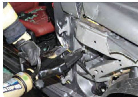
Imagen 295. Corte superior del montante A
