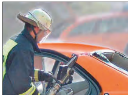
Imagen 255. Corte del montante C
