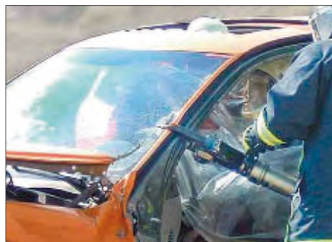
Imagen 286. Corte de los montantes A
