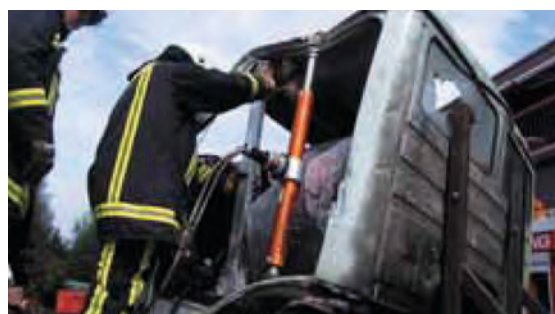
Imagen 330. Uso de cilindro de separación para empujar el techo
