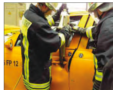
Imagen 189. Maniobra de separación vertical desde arriba
