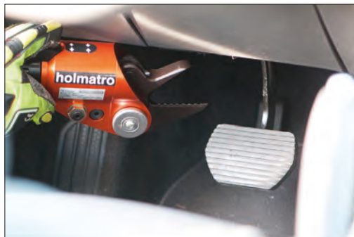
Imagen 305. Trabajo con el cortapedales
