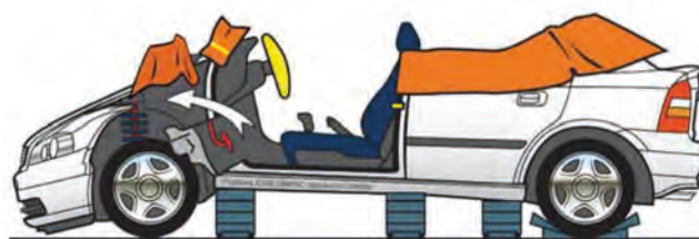
Imagen 303. Liberación del atrapamiento por pedales
