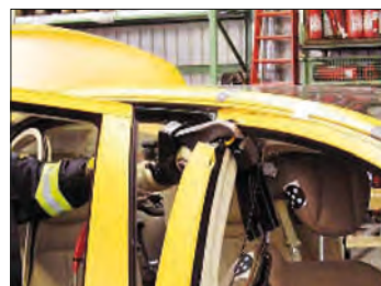
Imagen 217. Corte en el montante B
