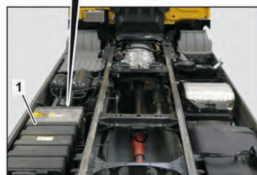
Imagen 126. Interruptor (2) de desconexión de baterías (1)
