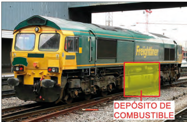
Imagen 27. Ubicación de los depósitos de combustible
