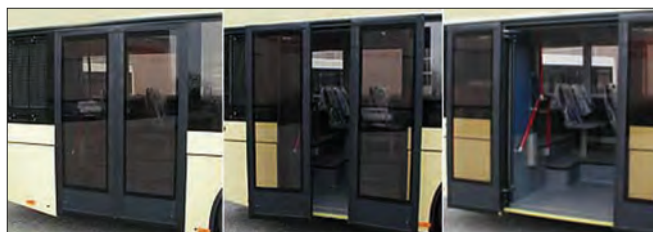
Imagen 348. Puertas basculantes que se abren hacia fuera
