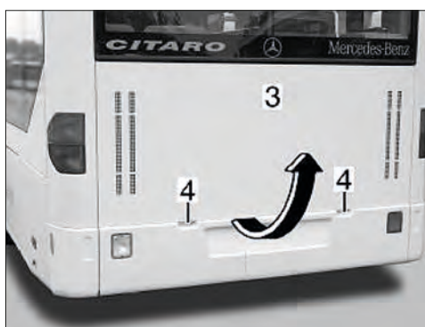
Imagen 111. Apertura del compartimento del motor
