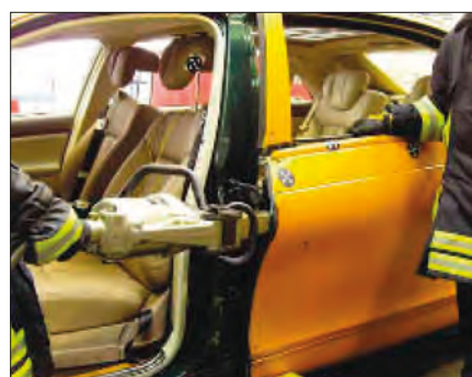
Imagen 211. Apertura de la puerta trasera
