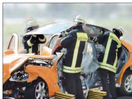
Imagen 256. Retirada del techo
