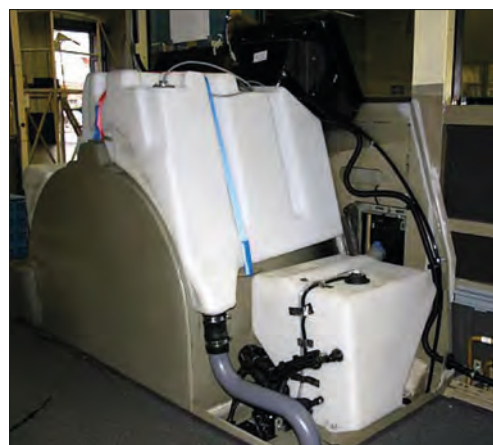
Imagen 344. Autobús urbano. Depósito en el chasis y depósito con superficie de asiento
