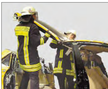
Imagen 266. Abatimiento parcial del techo
