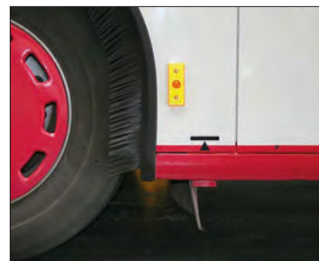
Imagen 166. Puntos de apoyo de autocares y autobuses
