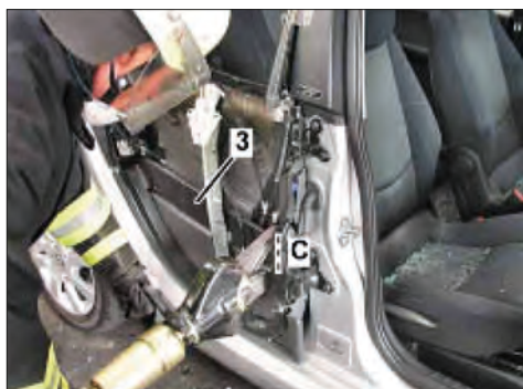
Imagen 312. Sección del travesaño (corte C)
