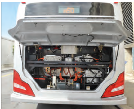
Imagen 123. Ejemplo de Baterías en autobuses
