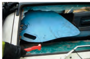
Protección en la rotura de cristal templado
