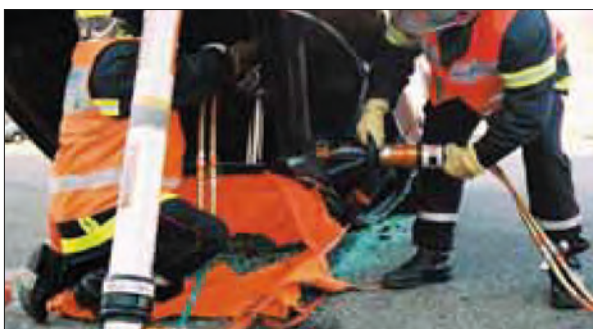
Imagen 278. Corte de pilares B y C
