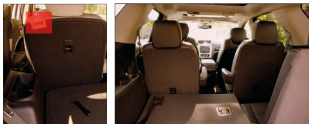
Imagen 234. Sistemas de abatimiento de los asientos traseros
