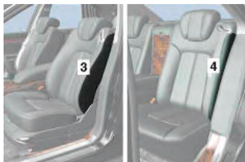
Imagen 175. Airbag lateral delantero (3) y airbag lateral trasero (4)
