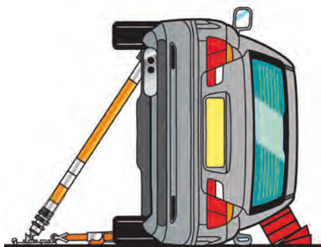
Imagen 148. Estabilización de vehículo sobre su costado
