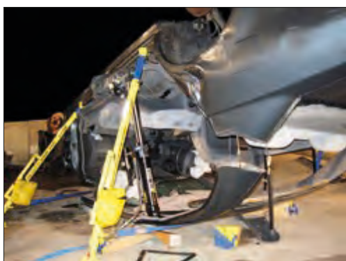
Imagen 158. Prever la ruta de extracción en la estabilización
