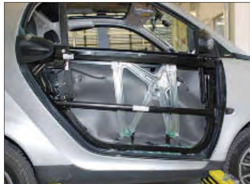
Imagen 308. Puertas de plástico sin revestimiento del Mercedes Smart
