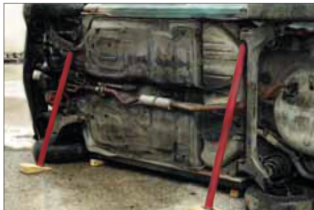
Imagen 151. Puntales mecánicos reforzados con cuñas
