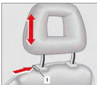
Imagen 237. Dispositivo de desbloqueo (1) del reposacabezas
