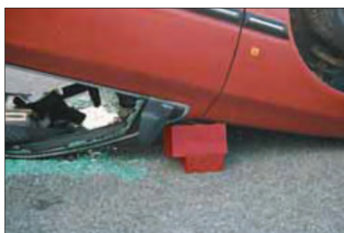
Imagen 159. Uso de bloques adicionales
